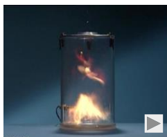
Fassexplosion durch Anhaftungen EH_520_ANV
